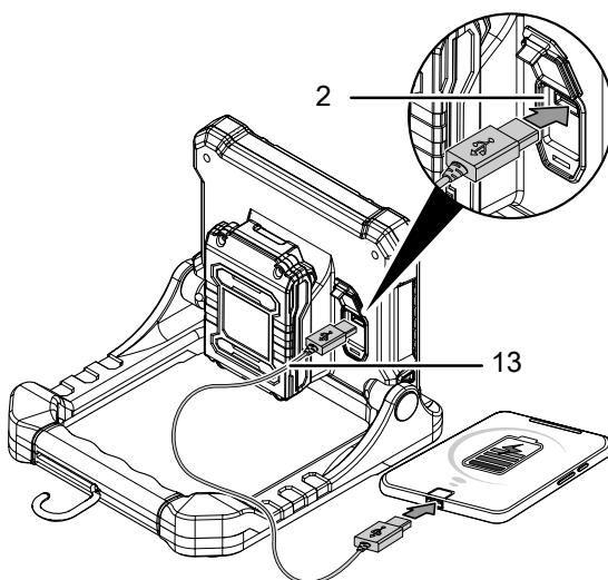
Ako uređaj želite upotrebljavati kao prijenosno napajanje, postupite na sljedeći način:
